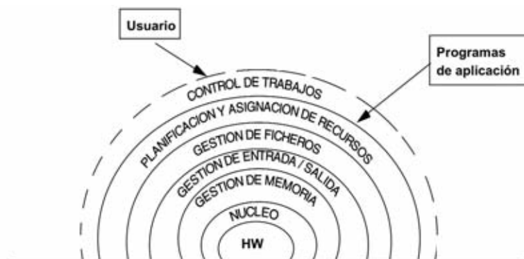
Fig.1. Sistema operativo construido a base de capas, o máquinas virtuales. [Fernández, Sáez Vacas, 1984, p. 717]
